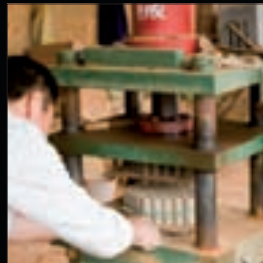
De tubes worden machinaal gevuld met klei. Eén kant van de tube is altijd gedicht met klei om het ontsnappen van chemicaliën en verbrandende gassen aan die kant te voorkomen.
